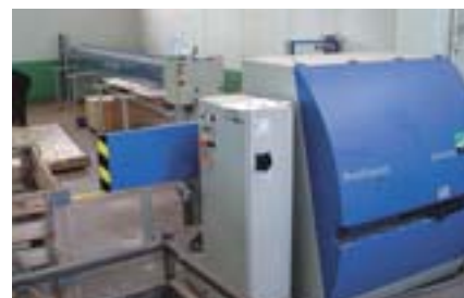
Línea Profijoint de GreCon Dimter para empalme de madera mediante sistema finger-joint, adquirida por Alfonso y Gaspar Cabrero, S.A.
